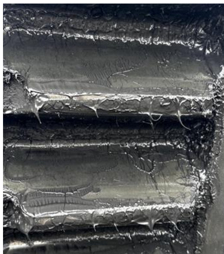
MC Alumix OG 1500-0 на зубчатой передаче стрелы
