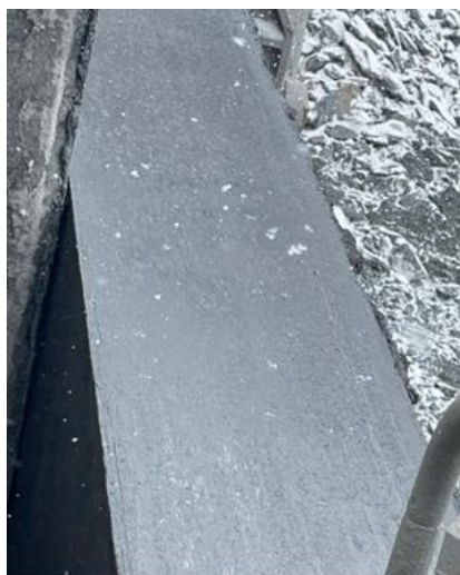
MC Alumix OG 1500-0 на поверхности стрелы скольжения
