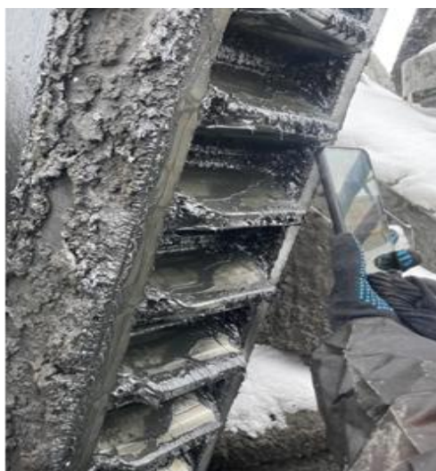
MC 1400 OGW-0 на зубчатой передаче стрелы
