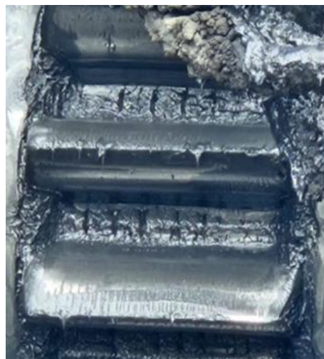
MC Alumix OG 1500-0 на кремальерной шестерне механизма напора стрелы
