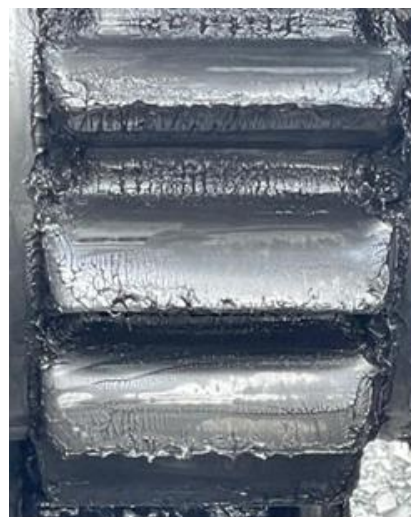
MC Alumix OG 1500-0 на кремальерной шестерне механизма напора стрелы
