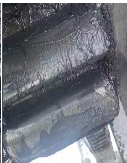
MC 1400 OGW-0 на кремальерной шестерне механизма напора стрелы
